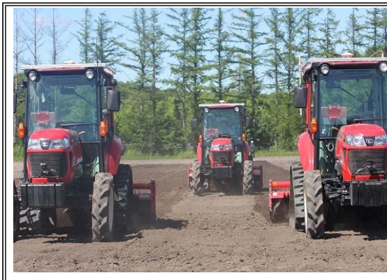
ロボットトラクタ3台による協調作業
