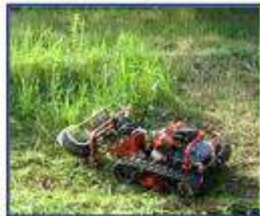
畦畔での除草作業をロボット化し、省力化、作業安全の向上を実現
