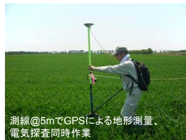
移動式電気探査システムによるライン探査(麦作付中でも探査が可能)
