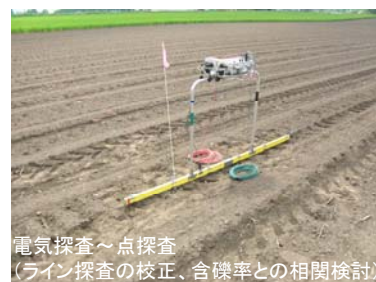
測線@5mでGPSによる地形測量、電気探査同時作業
