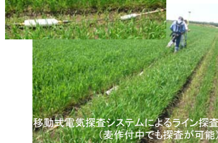
測線@5mでGPSによる地形測量、電気探査同時作業
