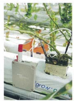
二 / 灰色の箱が、培地に設置した複合環境制御システムのセンサー。右 / センサーが測った数値やデータを、農場内のパソコンで管理し、制御する。
