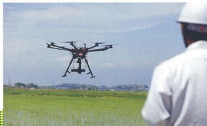
現在は高度30mから測定するが、将来カメラの解像度が上がれば、さらに高い場所から、より広い範囲を測定できるようになり作業効率上がる。
